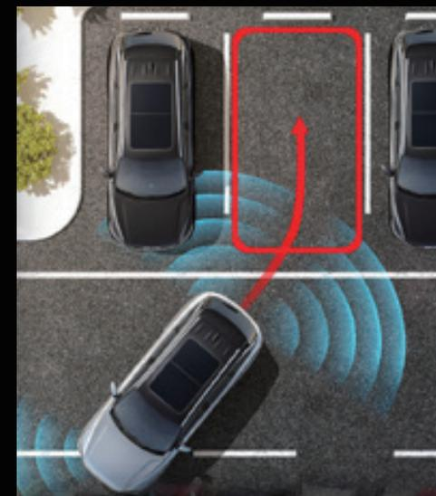
**Asistente de estacionamiento automático (APA), con 12 sensores ultrasónicos y 4 cámaras.**
